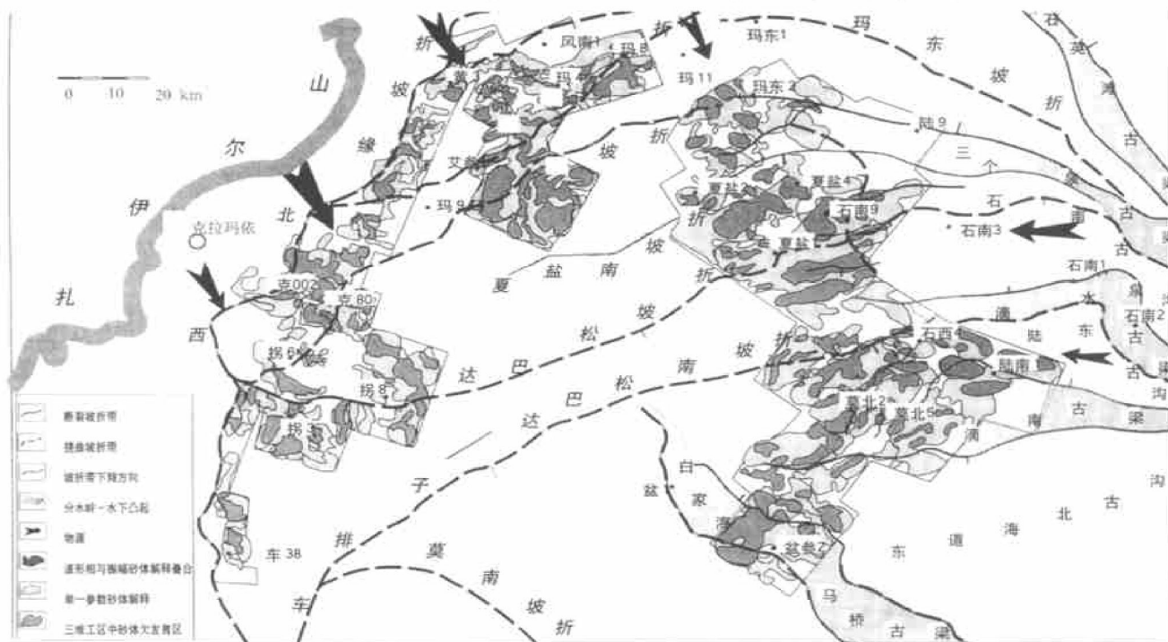
图 3 准噶尔盆地西北缘-腹部地区侏罗系 III 层序底界上延 40 ms 波形地震相与沿层振幅切片砂体解释叠合图
